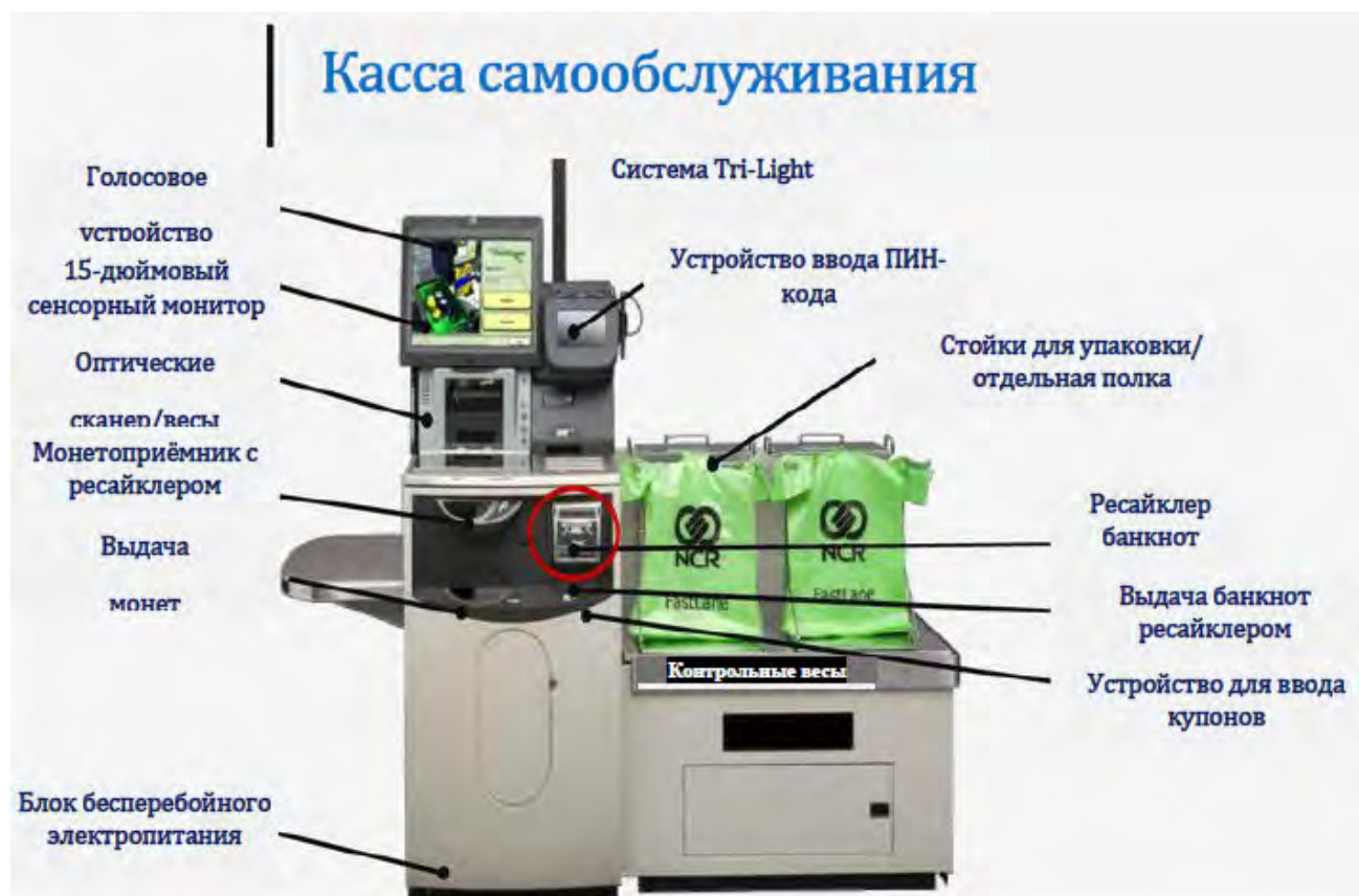
Рисунок 3. Устройство КСО
