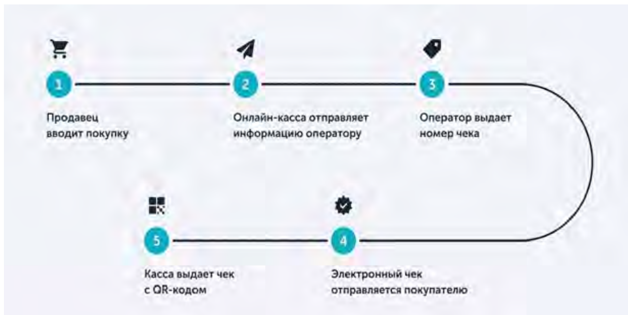
Рисунок 2. Принцип работы онлайн-кассы
